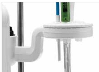
El portaelectrodos es fácil de voltear para proporcionar mayor altura.
