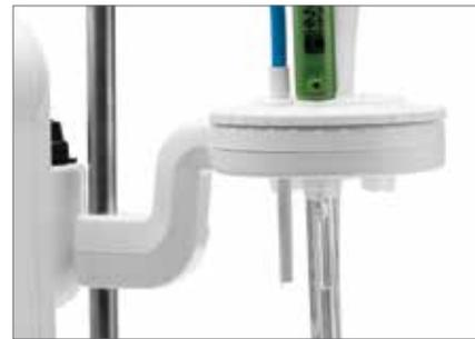
El soporte del electrodo se puede desplazar para ajustar la altura.
